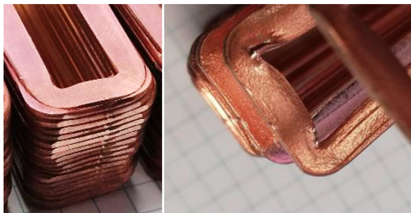
Bild 7: Verjüngung der Drahtbreite in den Eckbereichen der Formspule.
