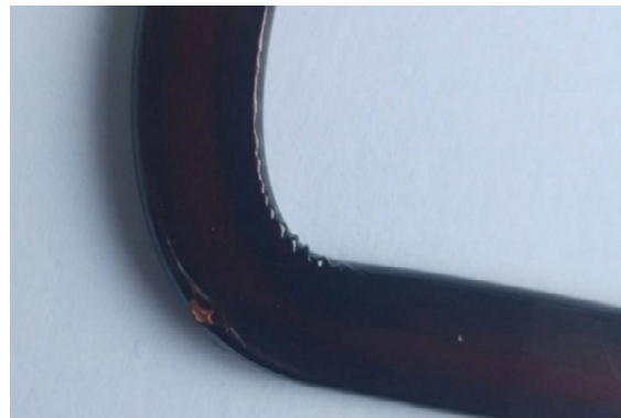
Bild 8: Gemessene TE-Einsetzspannungen in Abhängigkeit der Endhöhe der Proben (links) und umgeformte Probe mit aufgeplatzttem Lack (rechts).
