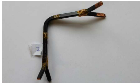
Bild 7: Ersatzanordnung zur Untersuchung der TE-Einsetzspannung der Formspule.
