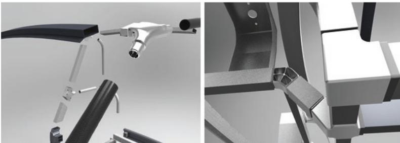
**Abb. 6.12** Profile und Knotenstrukturen im FlexBody-Karosseriebaukasten
