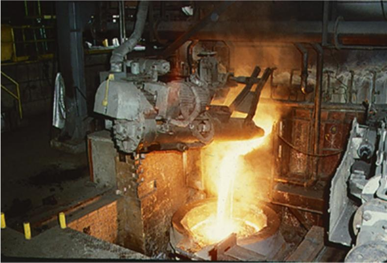
**Abb. 5.46** Legierungsabstich aus dem LBO bei Inmetco. (Quelle: Inmetco Inc. 2009)
