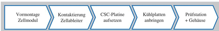
Abb. 6.65 Montageprozess des Batteriemoduls
