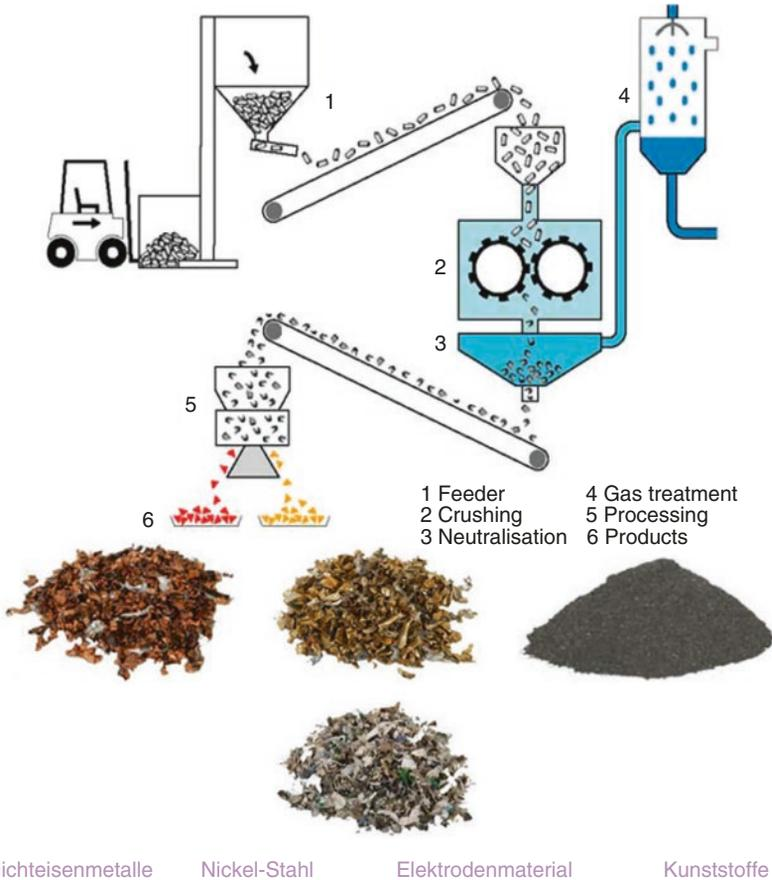
**Abb. 5.45** Mechanische Aufbereitung bei Batrec. (Quelle: Batrec Industrie AG 2009)
