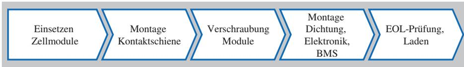
**Abb. 6.67** Montageprozess des Batteriepacks
