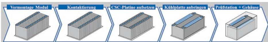
Abb. 6.66 Entwicklung bei der Assemblierung des Batteriemoduls
