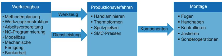
**Abb. 6.21** Operative Prozesskette für Kunststoffkomponenten
