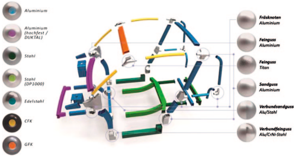
Abb. 6.13 Beispielhafte Material- und Fertigungsmischung beim FlexBody-Karosseriebaukasten
