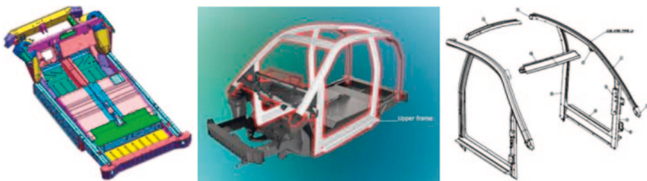
Abb. 6.10 THINK CITY – Karosserieaufbau in Material- und Fertigungsmischbauweise mit Stahlblech-Bodengruppe sowie Aluminium-Aufbaustruktur und Kunststoffbeplankung (in Anlehnung an Mollestad 2010)
