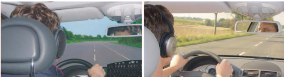
Abb. 5.15 Fahr simulatoren; links: stationärer Fahr simulator (mit Videoprojektion), rechts: mobiler Fahr simulator (auf der Straße)
