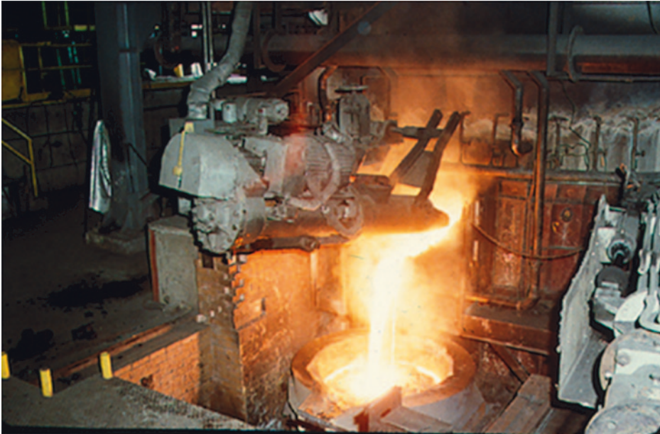
Abb. 5.45 Legierungsabstich aus dem LBO bei Inmetco. Quelle Inmetco Inc. (2009)
