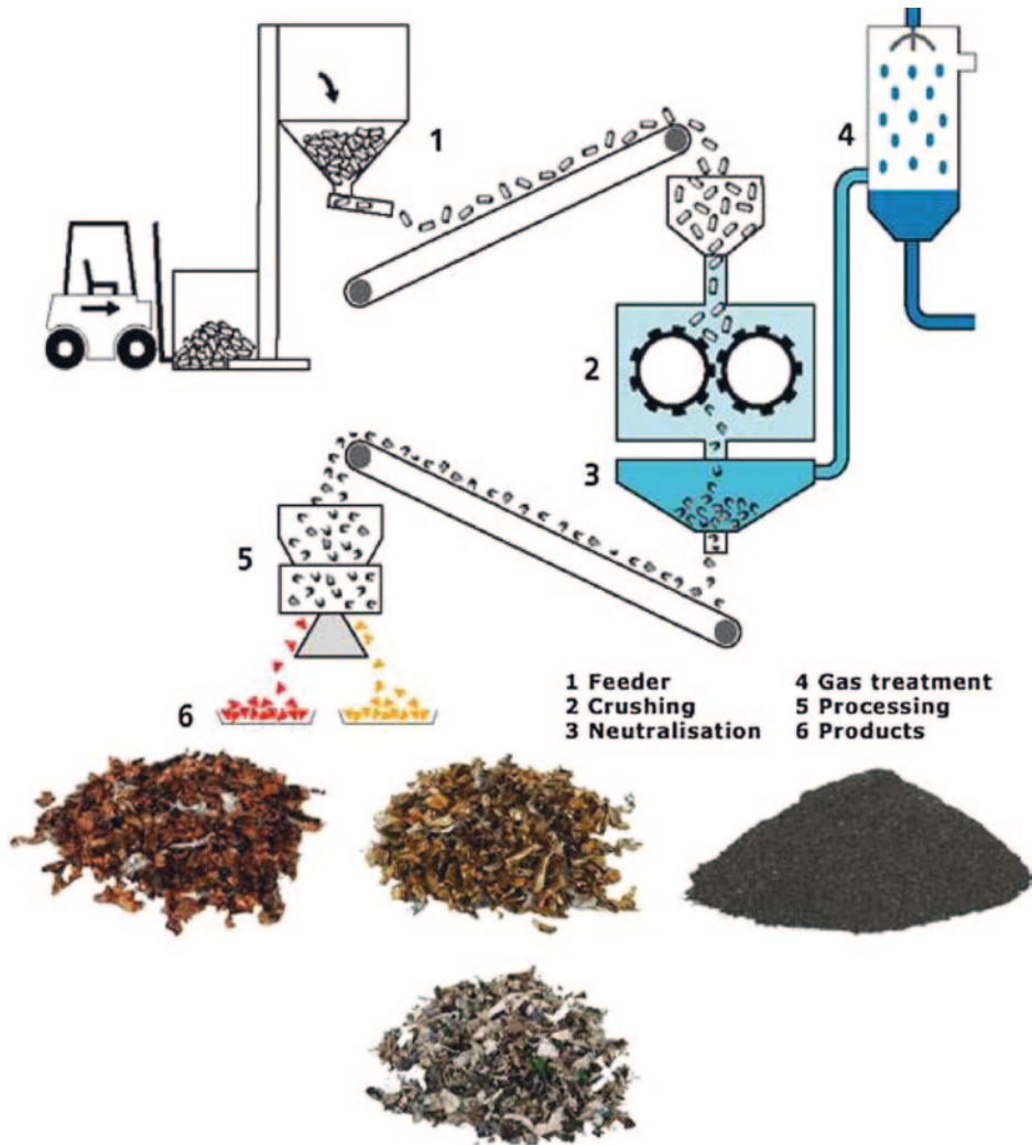
Abb. 5.44 Mechanische Aufbereitung bei Batrec. Quelle Batrec Industrie AG (2009)
