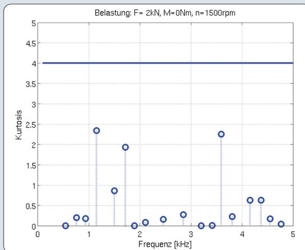
8: Kurtosis für jede Fehlerfrequenz bei Speisung mit dem Umrichter (links) und Speisung mit dem Leistungsverstärker (rechts) bei Messkombination: 001
