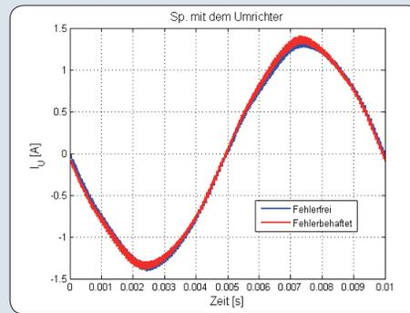
4: Stromverlauf bei Speisung mit dem Leistungsverstärker (links), mit dem Umrichter (rechts). Messung mit folgender Belastung: Lastkraft  $F=2\text{kN}$ , Lastmoment  $M=0,1\text{Nm}$  und Drehzahl  $n=1500\text{U/min}$  (101).
