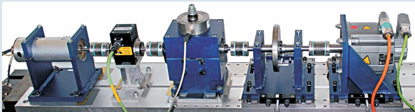
1: Mechanischer Aufbau des Prüfstandes mit Prüfmotor, Messwelle, Lagermodul, Schwungrad, Lastmotor (von links)
