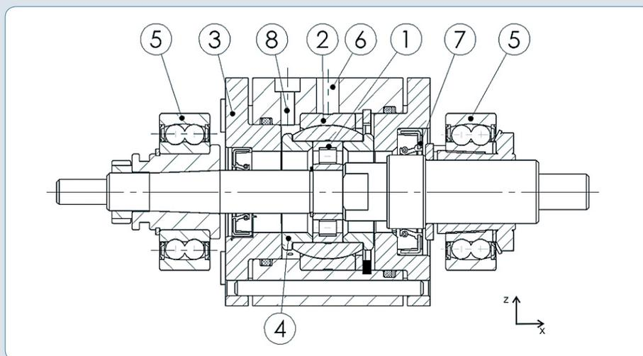
2: Prüflager mit Welle und Innengehäuse (ohne Umgebungsstruktur)
