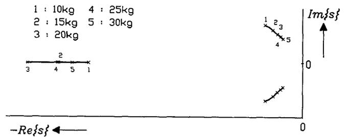
Bild 6. Ortskurve der Eigenwerte des rückgekoppelten Systems bei Variation der Systemmasse
