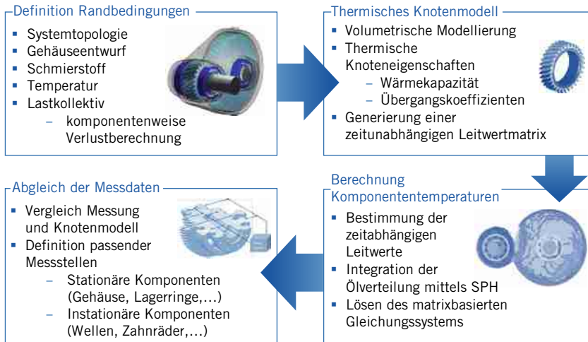
BILD 4 Matrixbasierte Generierung thermischer Netzwerke unter Nutzung von SPH-generierten Ölverteilungen (© ika)
