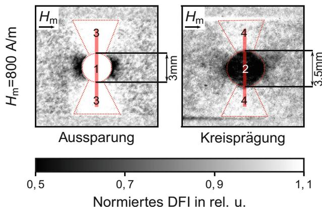
**Abb. 9** Vergleich der Verdrängung des magnetischen Flusses durch Aussparung und Kreisprägung bei einem angelegtem magnetischen Feld von  $H_m = 800 \text{ A m}^{-1}$
