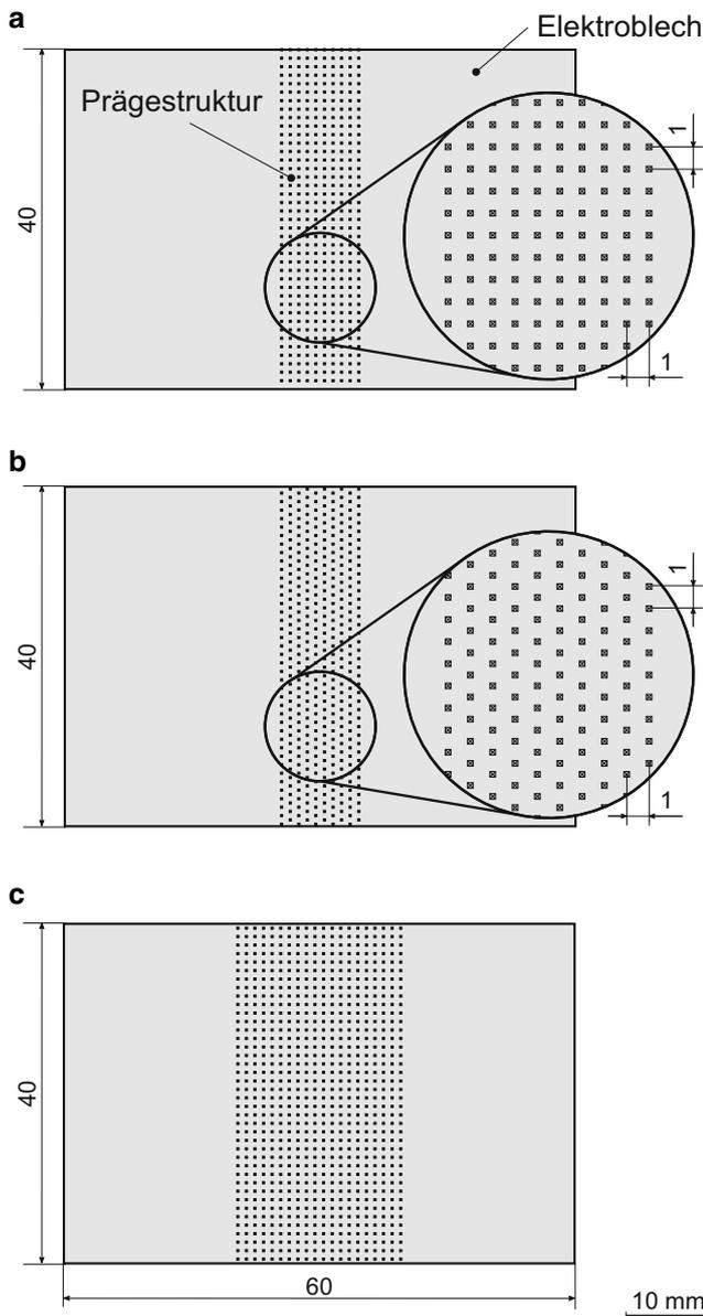
**Abb. 1** Schematische Darstellung der Probengeometrie mit homogener Prägung: **a** homogene Prägung; **b** homogene Prägung mit versetzten Prägelinien; **c** homogene Prägung mit doppelter Prägefläche
