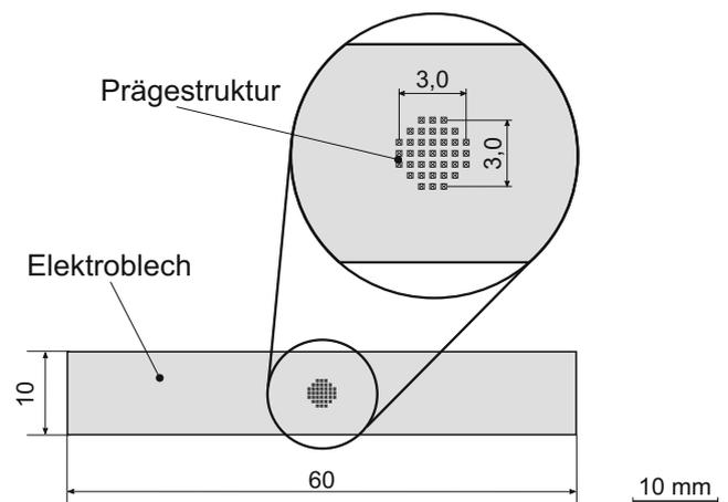
**Abb. 3** Schematische Darstellung der Probengeometrie mit Kreisprägung
