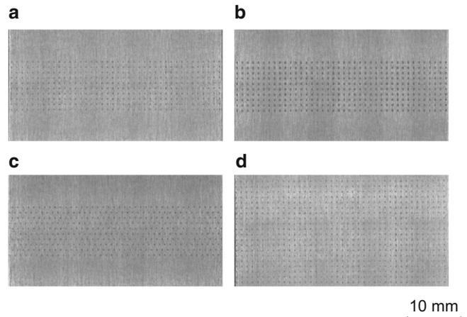
**Abb. 2** Nahaufnahmen der geprägten Bereiche der Probengeometrien mit homogener Prägung: **a** homogene Prägung mit 100 N Prägekräft; **b** homogene Prägung mit 200 N Prägekräft; **c** homogene Prägung mit versetzten Prägelinien mit 100 N Prägekräft; **d** homogene Prägung mit doppelter Prägefläche bei 100 N Prägekräft
