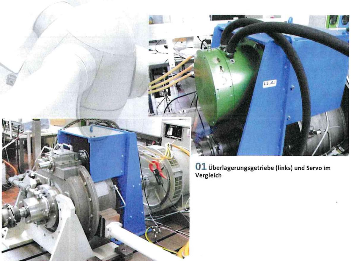
01 Überlagerungsgetriebe (links) und Servo im Vergleich
